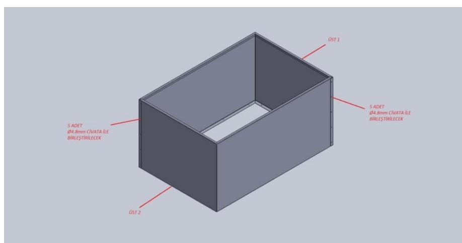
Для соединения верхней и нижней конструкций бункера понадобятся 18 штук болтов и гаек размером M10. Для крепления опорной ножки применяются 2 штуки болтов и гаек размером M10.
