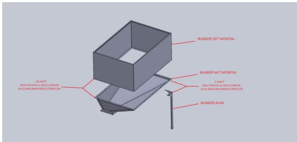
Чертеж 7- Установка опорной ножки сборного бункера
