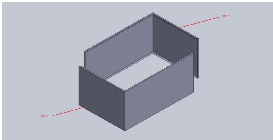
Для сборки металлических листов верхней конструкции бункера понадобятся 10 винков и гаек размером 4.8 мм, поставляемых в комплекте. Для сборки применяются 5 болтов для фиксации каждой стороны.
