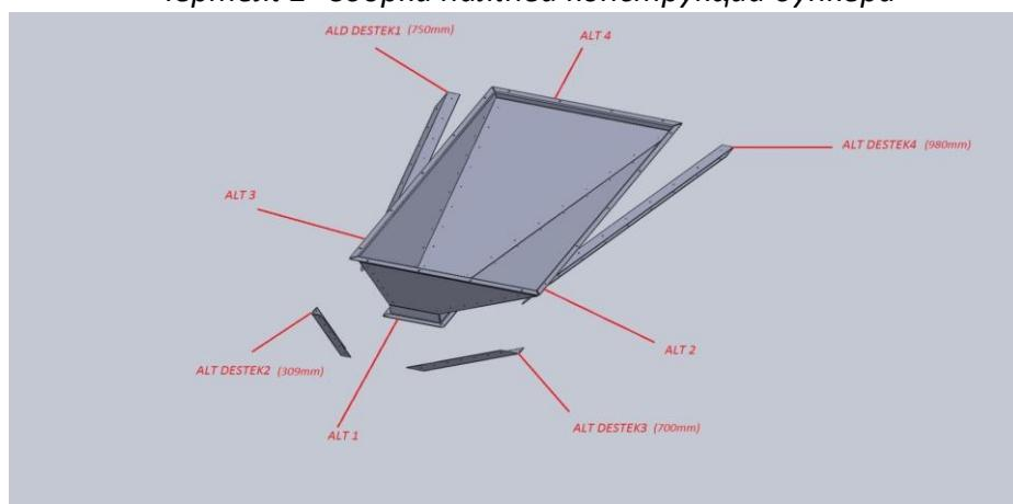
Чертеж 3 – Собранная нижняя конструкция бункера
