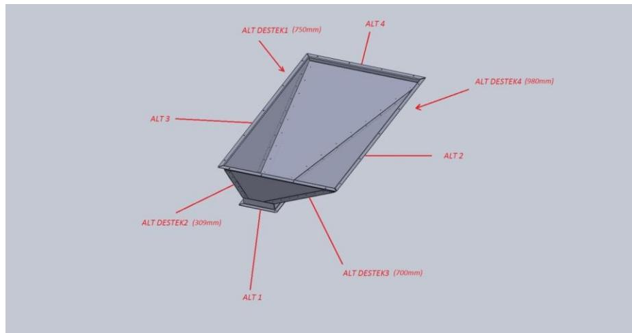
Верхняя конструкция топливного бункера состоит из 2 металлических листов, согнутых под прямым углом, как показано на чертеже ниже.
